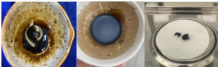
Сурет 2.7 – Экстракцияланған және ылғалсыздандырылған асфальтен
