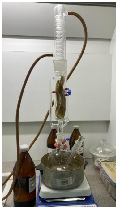
Сурет 2.6 - Сокслет аппаратын қолдана отырып, асфальтендерді экстракциялау
