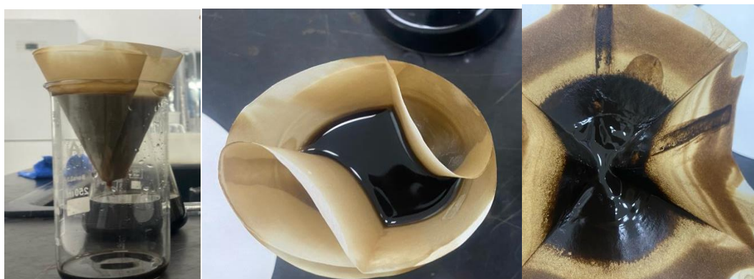
Сурет 2.5- Қаражанбас мұнайындағы тұнған асфальтендерді сүзу процессі
