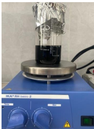
Сурет 2.8 – Экстракцияланған асфальтеннен дайындалған модельдік май
